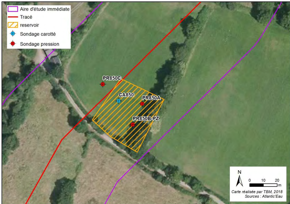
Figure 5 : Extrait SIG implantation des sondages géotechniques
